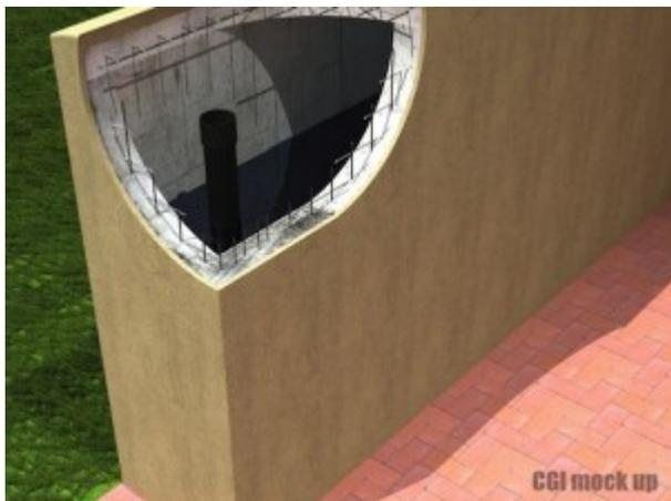
Walls 2.0 con una pioggia di circa 2,5 cm ed una copertura di 100 mq è in grado di immagazzinare fino a 2.300 litri d'acqua
